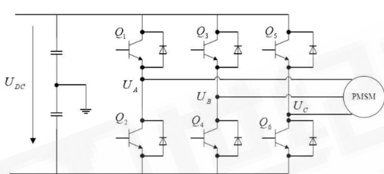
图 3-1 三相电压逆变电路示意图
